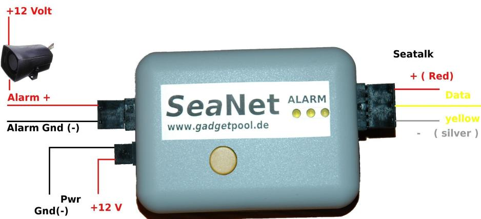
Gerätealarme sind oft nicht laut genug, um im Inneren des Schiffes gehört zu werden - oder gar, um eine schlafende Crew zu wecken. Selbst wenn z.B. der Ankeralarm am SeaTalk Gerät aktiviert ist, ist es nicht sicher, dass die Crew geweckt wird.
